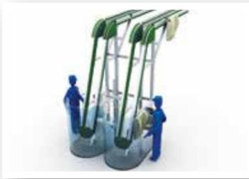
Robuste Kettenführung und Laufschienenkonstruktion für wartungsarmen und störungsfreien Langzeitbetrieb.
